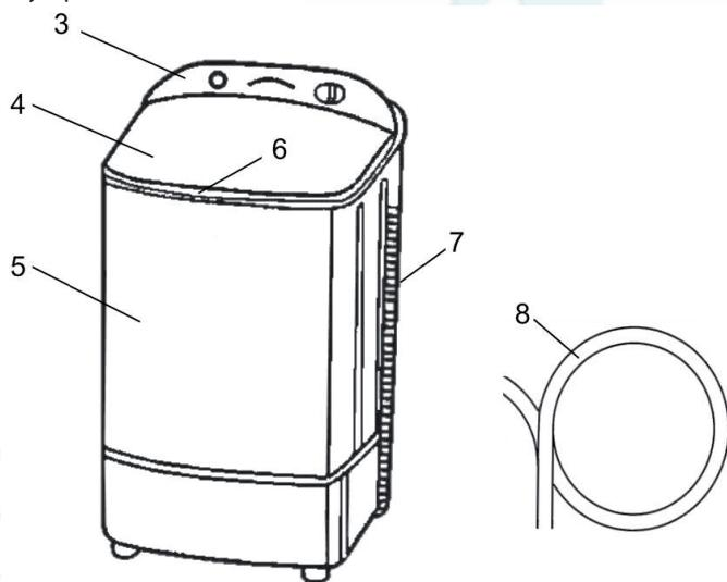
3 - панель управления; 4 - крышка бака для стирки; 5 - корпус машины;
