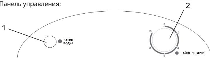
1 - отверстие для залива воды; 2 - таймер стирки.
